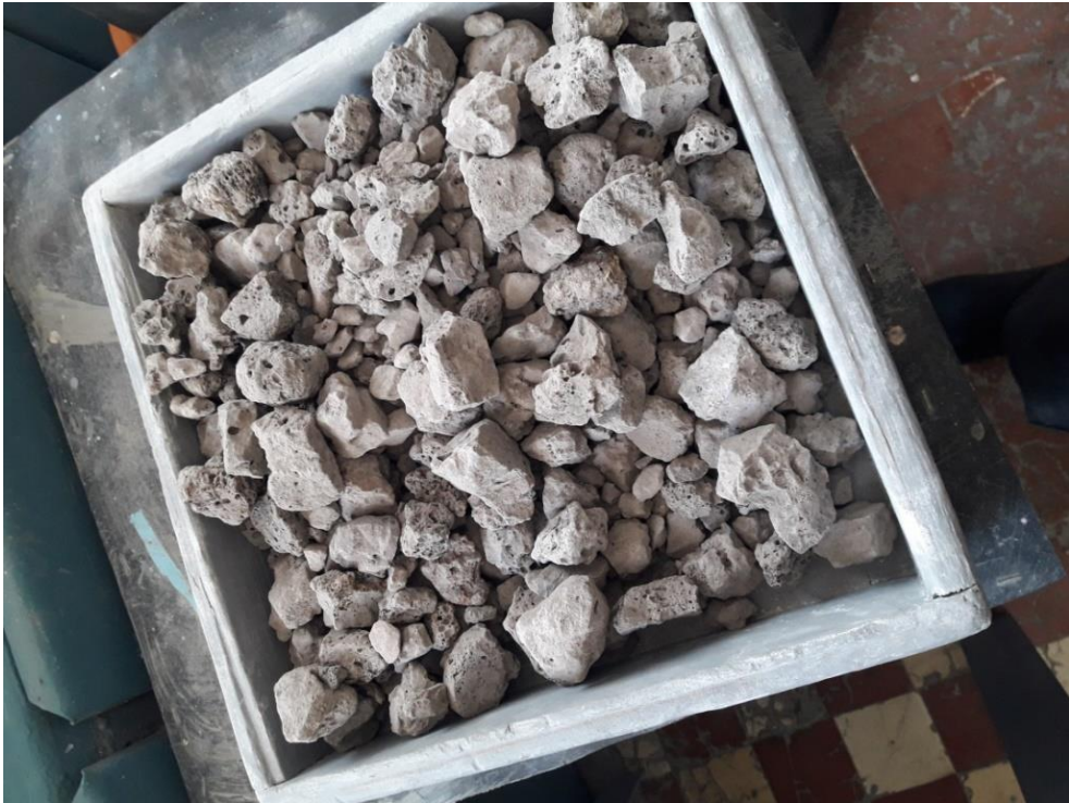
Рисунок 2.5. Определение показателей физико-механических свойств мартеновского шлака
