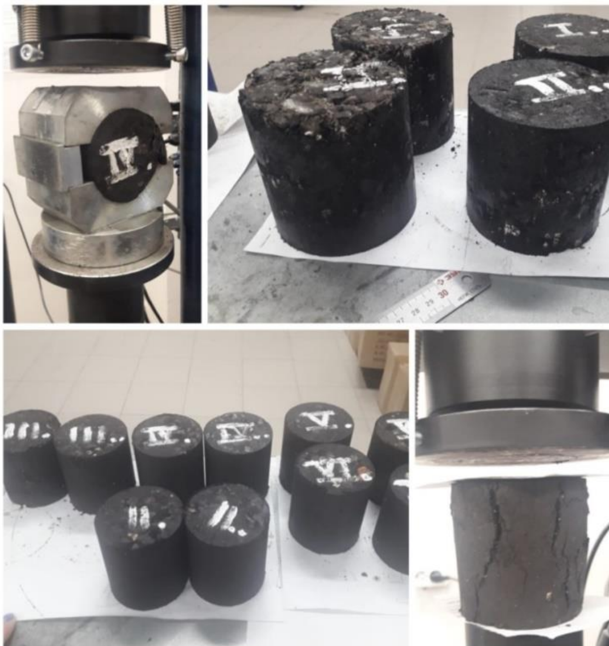
Рисунок 3.12. Определение показателей физико-механических свойств шлакоасфальтобетона
