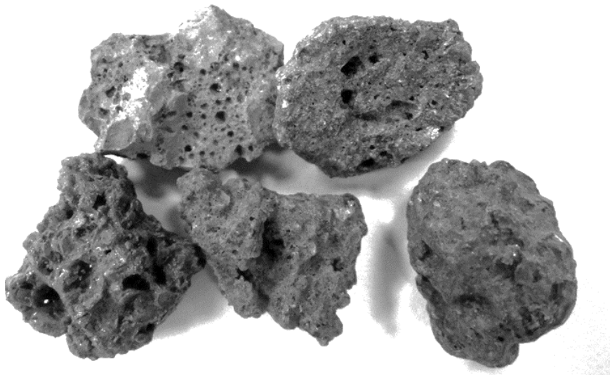
Рисунок 2.3. Пемзоподобные зерна сталеплавильного шлака
