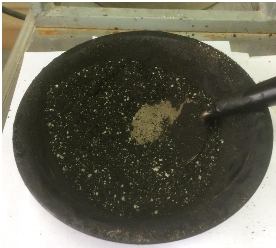
Рисунок 2.6. Приготовление битумоминеральной смеси из шлака печь-ковш
