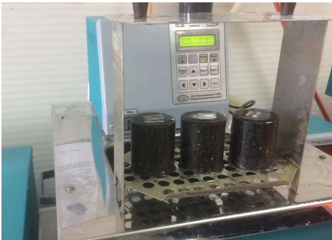
Рисунок 2.7. Испытание образцов битумоминеральной смеси из шлака печь-ковш на набухание
