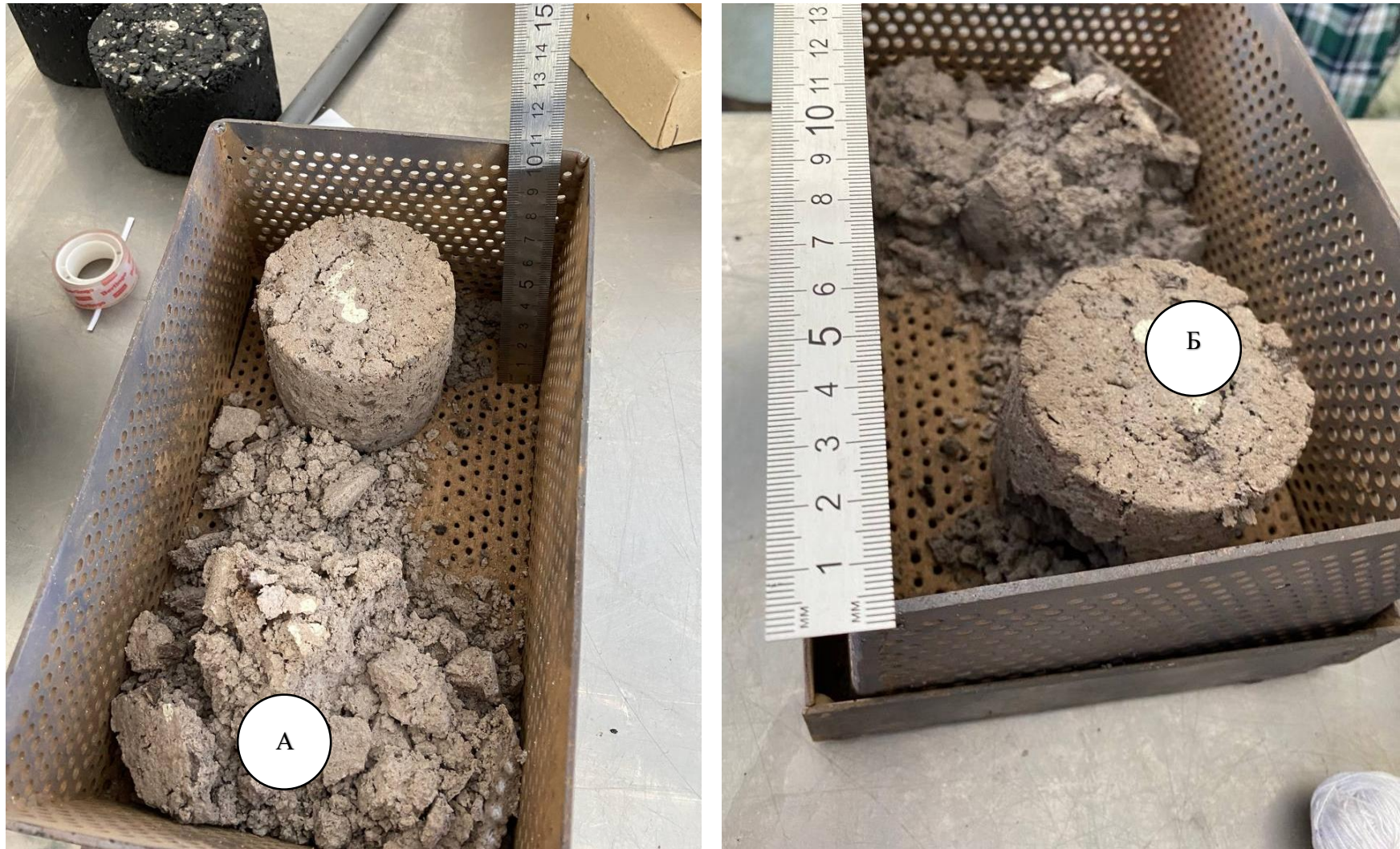
Рисунок 3.9. Образцы асфальтобетона после выжигания вяжущего в муфельной печи (через 21 сутки после насыщения водой): на традиционных заполнителях (А) и сталеплавильном шлаке (Б) [113]
